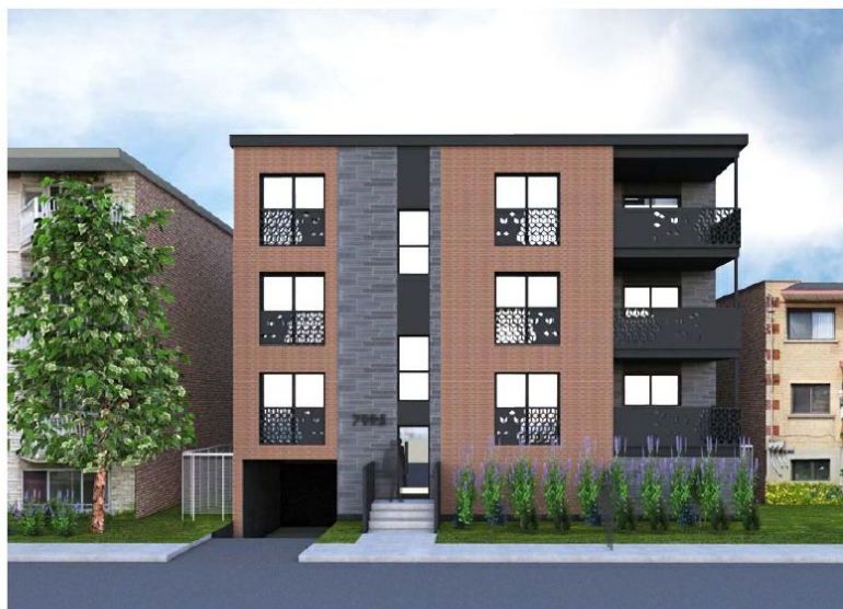
C1 BRIQUE DUNKERRON DE MERIDIAN FINI : LISSE - IRONSPOT DIMENSION : 3 1/2" X 11 1/2" X 3 1/2"
