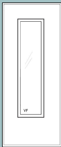
Porte simple Vitrage FIXE au centre ou décentré (largeur du vitrage peut varier)
