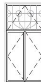
Fenêtre à guillotine \frac{1}{3} - \frac{2}{3} Vitraux dans la portion du haut
