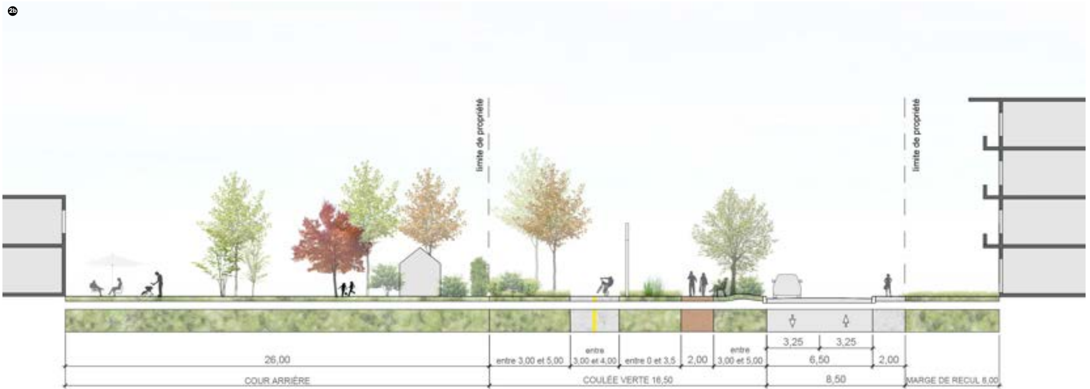
Fig. 195.Coupe type d’une piste multifonctionnelle
