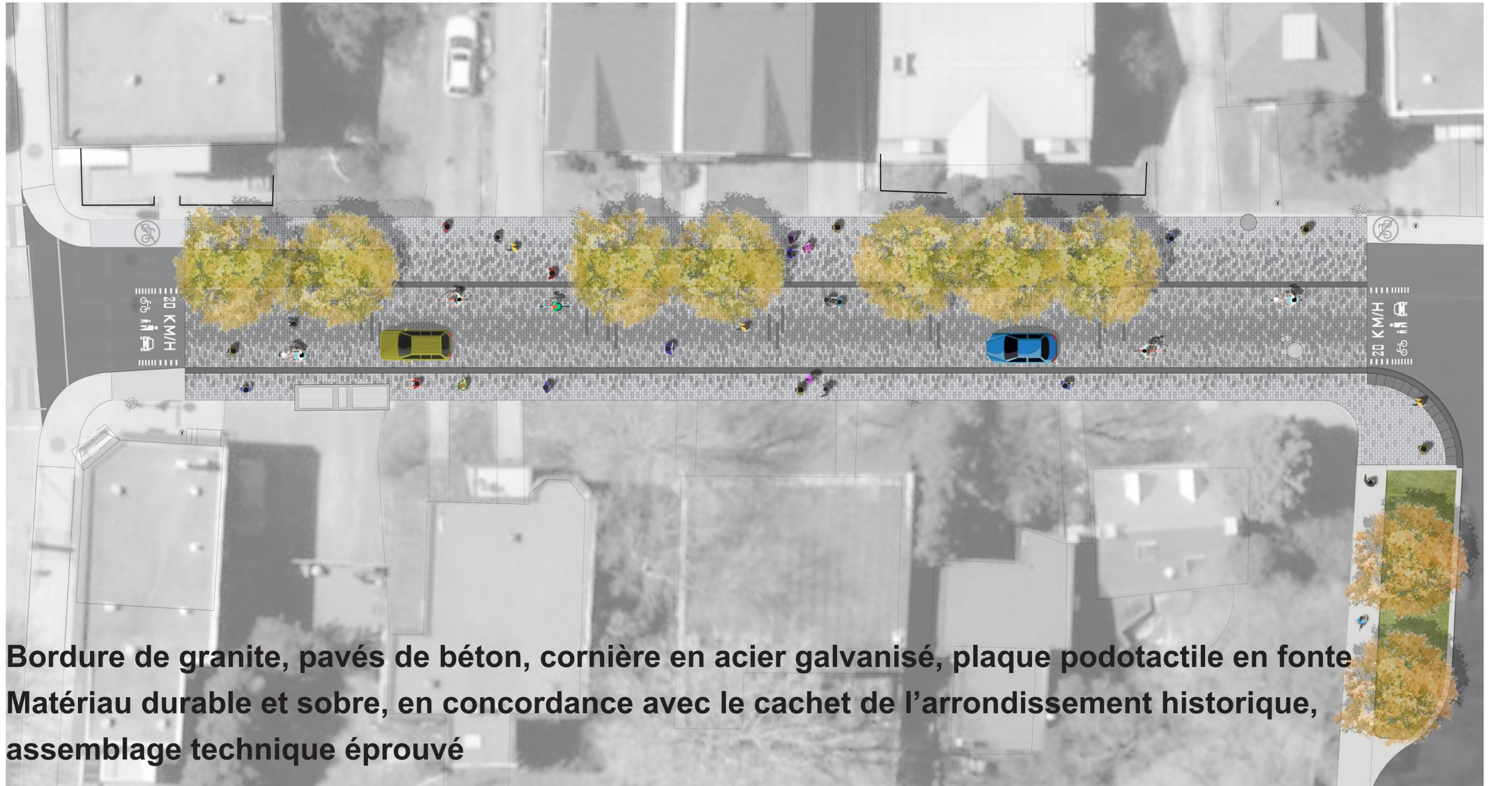
**Bordure de granite, pavés de béton, cornière en acier galvanisé, plaque podotactile en fonte**
