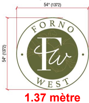
A ÉLÉVATION FACE 1X Échelle: 1/2" = 1' - 0" LOGO ROND DE TYPE CHANNEL LUMINEUX
